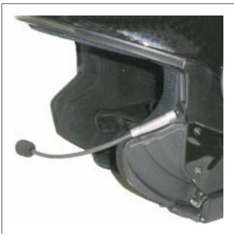
Markieren Sie sich im Helm den gewählten Platz für das Mikrofon und reinigen Sie gründlich die Polsterung im Bereich der Klebestellen, entfernen Sie dann das Schutzpapier auf der Klebefläche des Mikrofons und drücken sie dieses fest an, kann je nach Ausführung abweichen. Nun noch das Kabel verlegen und den Stecker mit dem blauen Anschluss der Elektronik-Box verbinden.
